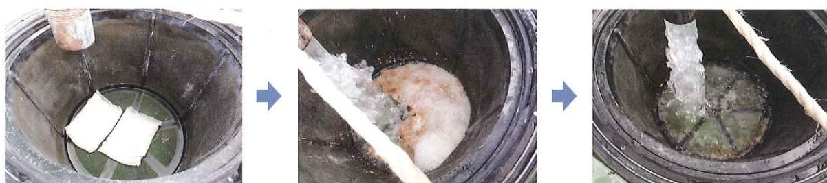
\*直接タンク車に投入すると、ダマになりやすいので、網の上に本製品を配置し、上から注水すると上手に溶けます。網がない場合は、タンク車に本製品を先に投入してから注水してください。
